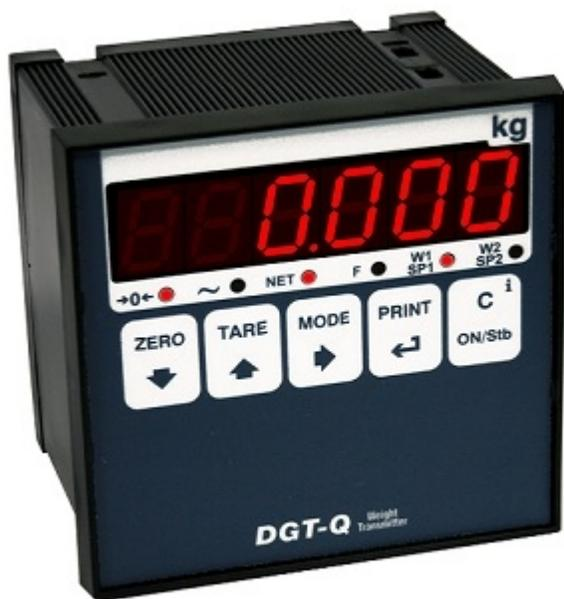
Indicatore / Trasmittitore di peso multifunzione da pannello, 4 canali dipendenti o indipendenti per la lettura diretta e diagnostica di ogni cella di carico collegata. L'ampia gamma di interfacce disponibili, rende più facile e sicura l'integrazione della pesatura in qualsiasi sistema di controllo e automazione. Omologabile CE-M (OIML R-76 / EN 45501).
