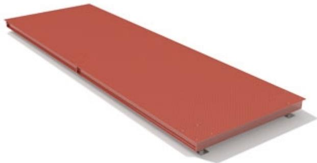
Kit pesa a ponte modulare di nuova generazione, per montaggio a filo piano stradale. Il kit comprende tutti i ponti, la scatola di giunzione, le celle di carico digitali con piastre snodate per autoallineamento e la bulloneria necessaria per realizzare una pesa a ponte.
